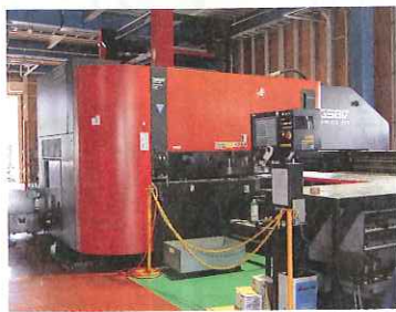
事務所にある3次元CADと、工場の3次元測定器、工作機械を光ファイバーで結び、コンピューターシステムで職人技を超高精度の板金加工作業に実践。夜間無人作業により稼働率を上げ、コストダウンと納期短縮を実現している。
