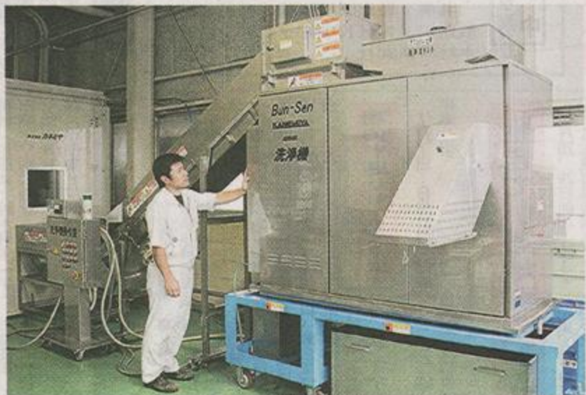
汚れたビニールやプラスチックを分別・洗浄する機械—半田市で
